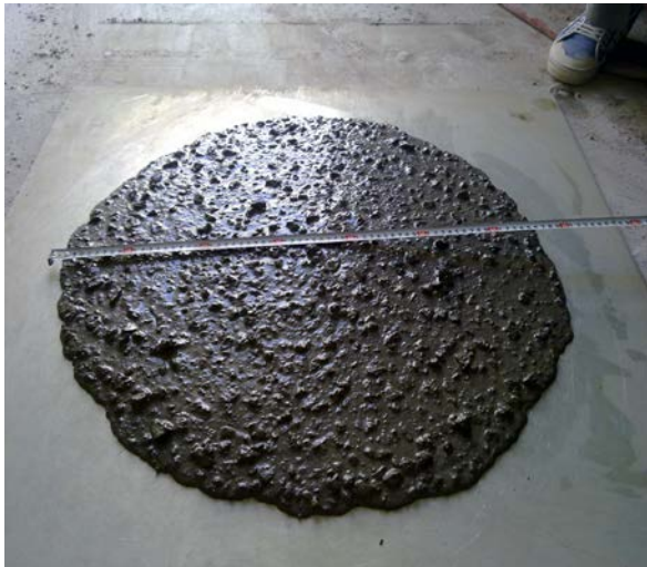
صورة رقم(3-2) قياس قطر الانتشار
