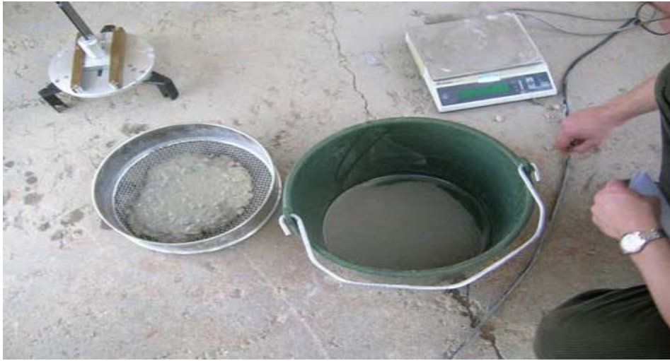
صورة رقم (4-3) تجربة الاستقرار في المنخل
