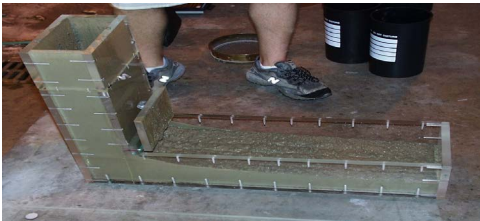
الصورة رقم (1-6) تجربة قابلية المرور
