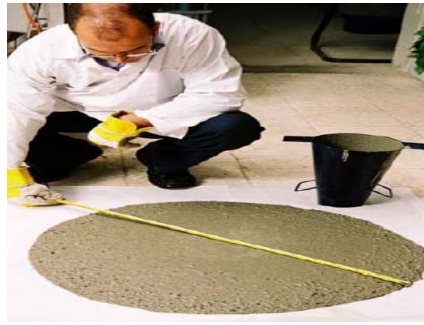
الصورة رقم (1-1) كيفية قياس قطر الانتشار
