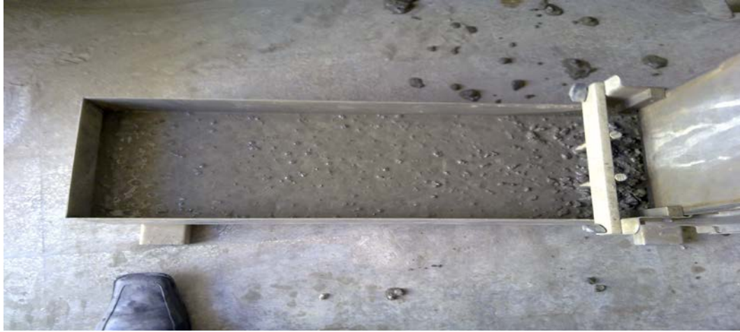
صورة رقم (3-3) إجراء تجربة قابلية المرور
