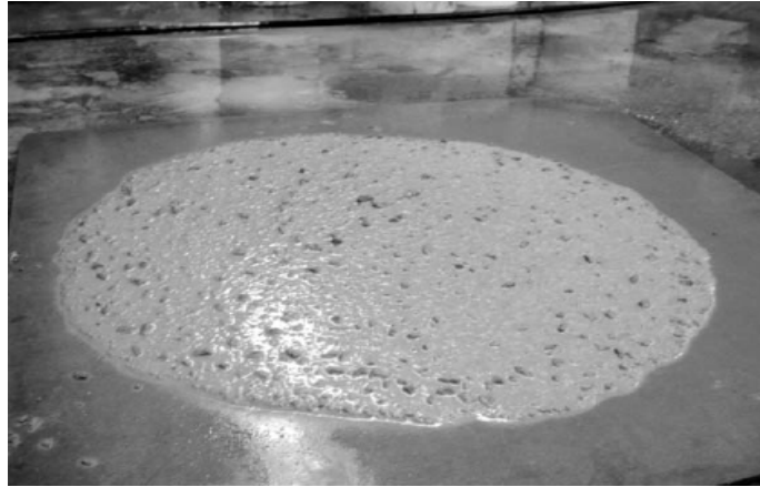
الصورة رقم (1-4) بيتون ذاتي التوضع قليل الثبات VSI=2
