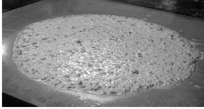
الصورة رقم (1-3) بيتون ذاتي التوضع ثابت VSI=1
