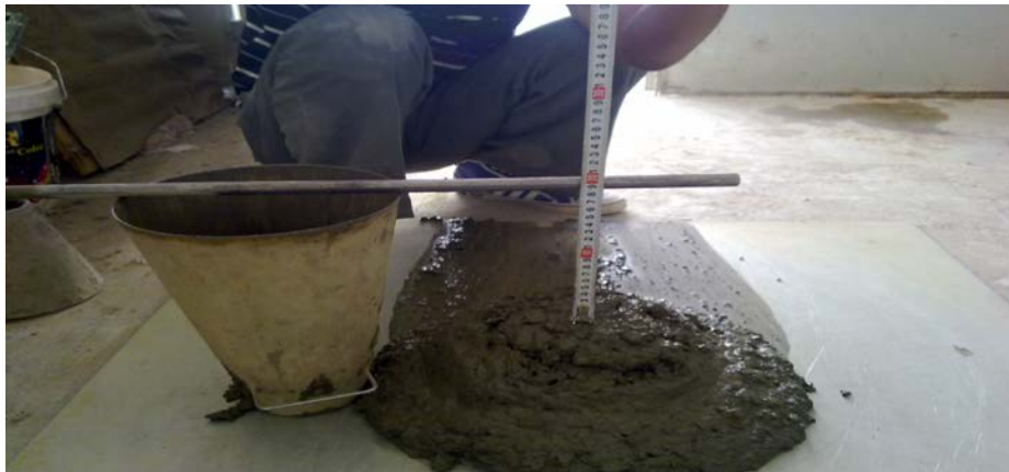
صورة (3-9) اختبار هبوط المخروط للببتون العادي
